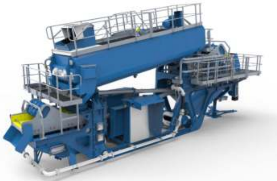
Illustration 5 : Modèle de déboureur « Aggmax 83 R » (source : CDE, 2021)
