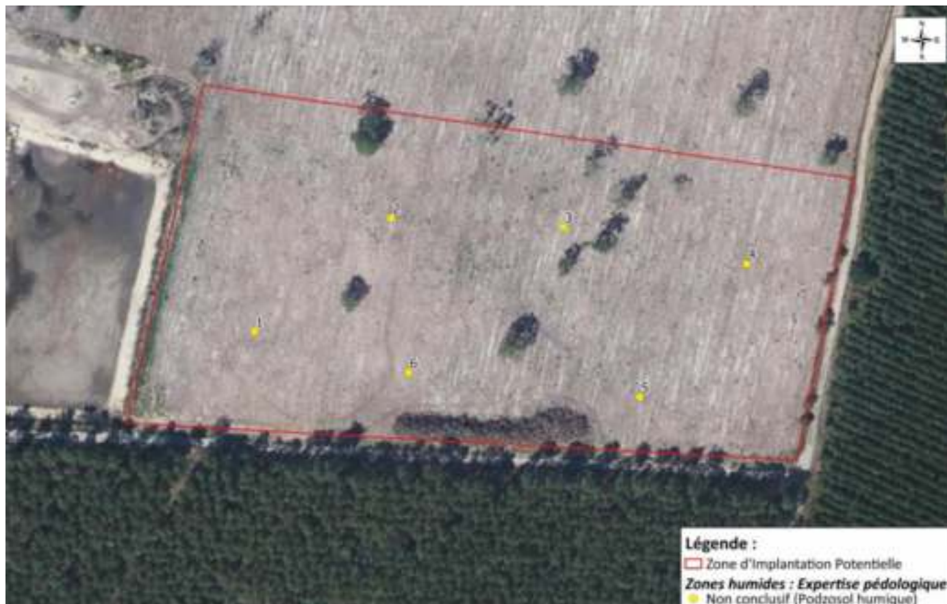
Illustration 19 : Localisation des sondages réalisés sur le site du projet (source : ETEN Environnement, Pré-diagnostic Zones Humides, Février 2023)
